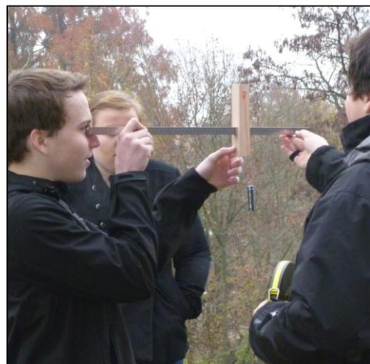
In der folgenden Doppelstunde werden die erworbenen Erkenntnisse genutzt um die Höhe eines Baums mit einem realen Jakobsstab zu bestimmen. Zur Vorbereitung dazu erarbeiten sich die Schüler die Handhabung des Jakobsstabs anhand einer Simulation (vgl. Abb. 3). Diese erleichtert auch das Herstellen der Beziehung zwischen dem Strahlensatz und der Messkonfiguration. Anschließend messen die Schüler mit dem Jakobsstab
