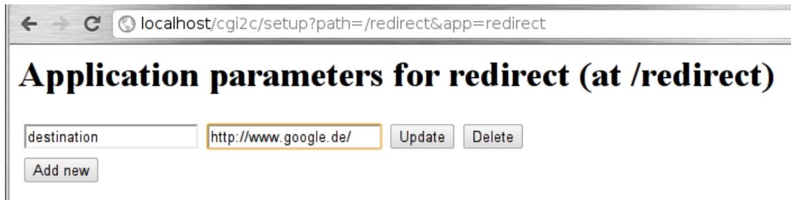
Abbildung 6.6: Das Einstellen von Parametern eines Web-Dienstes in Setup.
