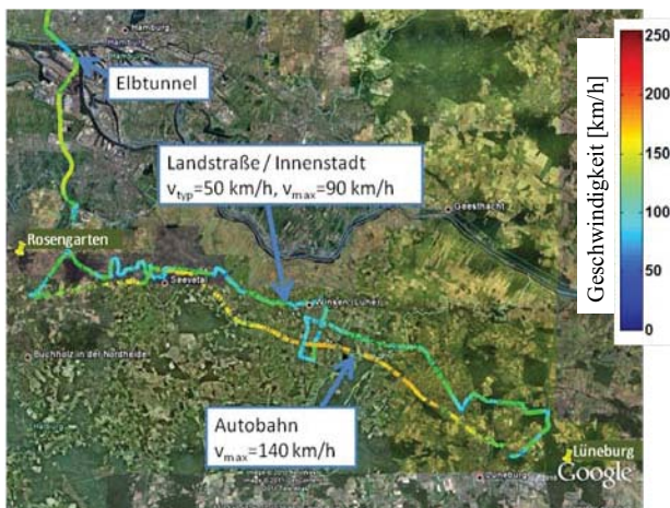
Bild 1 Messkarte, die verschiedene Bereiche der Mobilmessungen zeigt. Die farblich markierte Messroute stellt die unterschiedlichen Geschwindigkeiten dar. Die beiden Sender sind mit Nadeln markiert.
