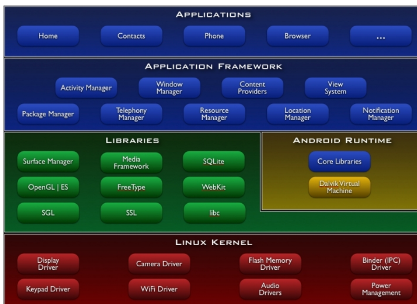
Abbildung 6.6: Aufbau der Android Plattform. Quelle: [Goo11b]
