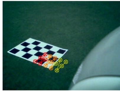
(b) Die Schachkreuzungen wie sie im Bild vermutet werden
