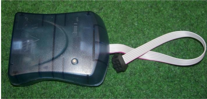
Abbildung 5.8: Programmieradapter von Atmel (AVRISP mkII) zum Aufspielen von Firmware auf Mikrocontroller.
