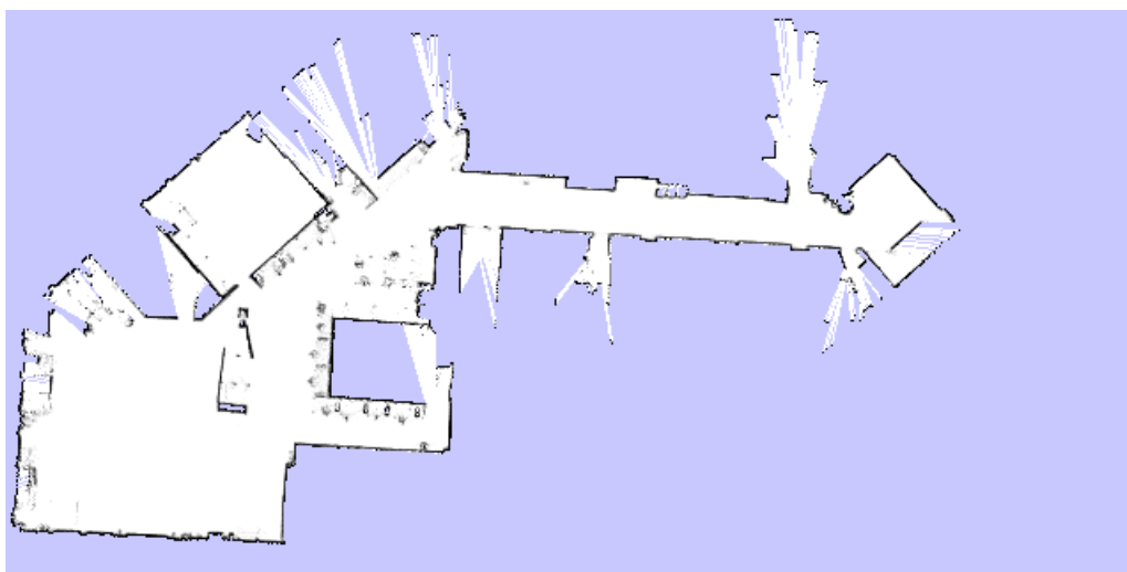
Abbildung 4.4: Rasterkarte unserer Testumgebung, erstellt mit GMapping. Freie Bereiche sind weiß markiert, Zellen die ein Hindernis darstellen schwarz. Alle Zellen über die keine Aussage getroffen werden konnte, sind blau gefärbt.
