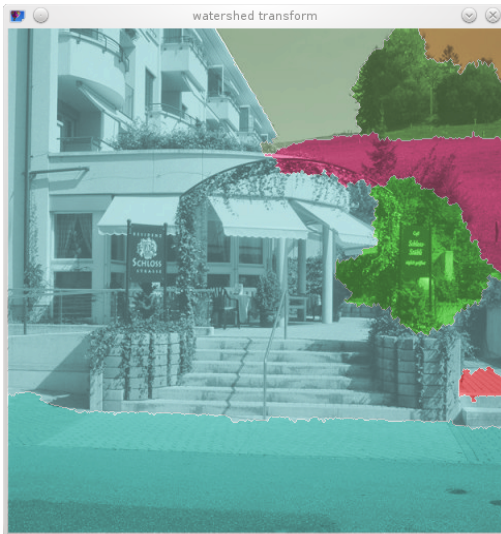
(a) Nach der Anwendung des Watershed Algorithmus vorliegendes Bild. In diesem können Segmente durch klicke ausgewählt werden.
