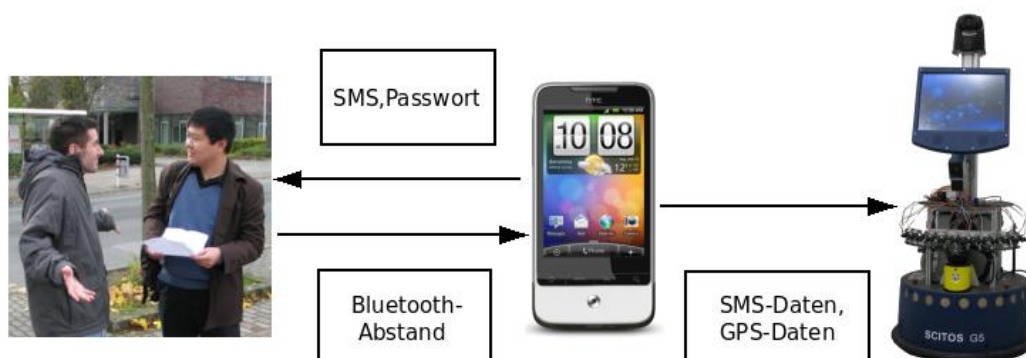
Abbildung 4.2: Übersicht der Kommunikation zwischen dem Benutzer, Smartphone und Roboter
