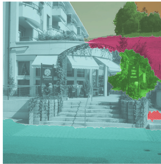
(d) Mithilfe des Watershed Algorithmus segmentiertes Bild. Die verschiedenen Flächen sind klar getrennt. Das Ergebnis hängt jedoch stark von der Wahl der Marker ab.
