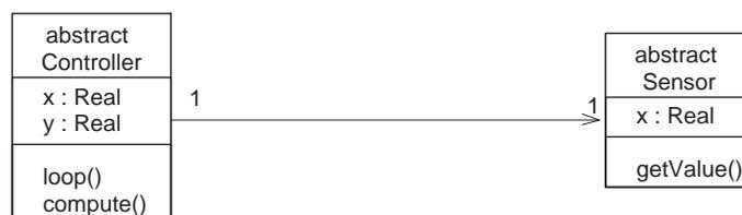
Abbildung 10.6: Das Klassendiagramm eines abstrakten Controllers ohne Actor
