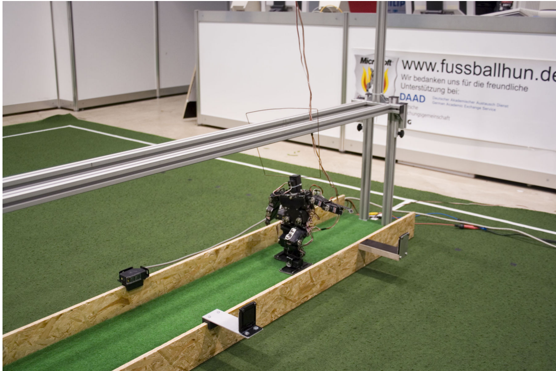
Abbildung 5.3: Gestell zum autonomen Laufenslernen eines zweibeinigen Roboters
