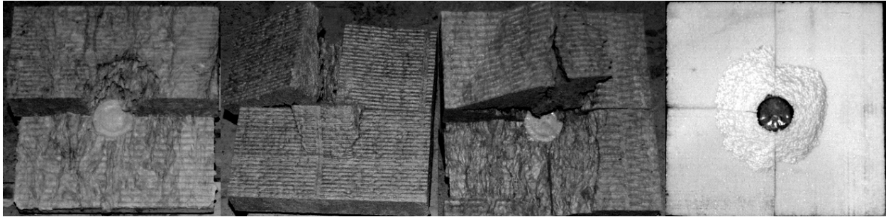
Bild 4.25 Vergleich der charakteristischen Versagensbilder der Dämmplatten im Durchziehversuch – Fugendübelung
