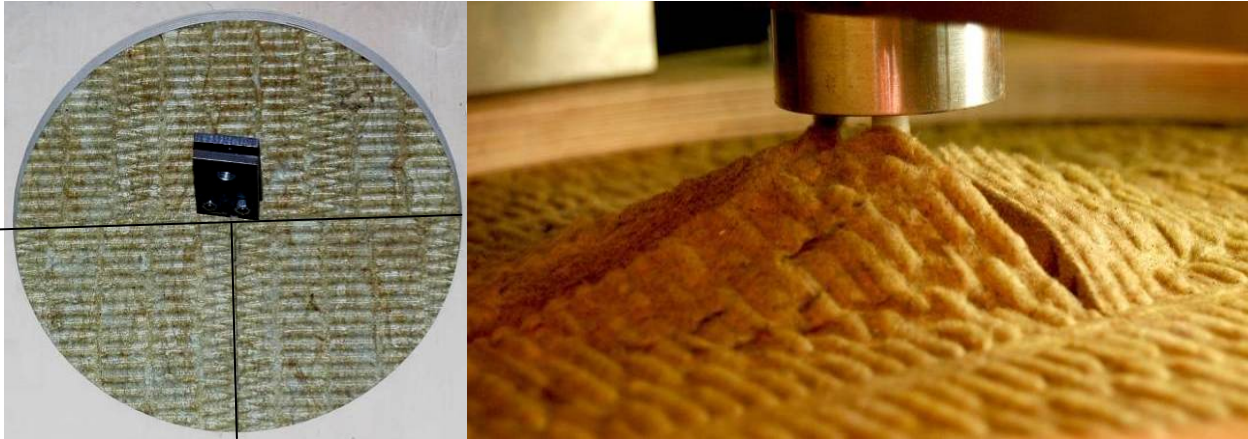
Bild 4.38 T-Fuge im modifizierten Schaumblockversuch auf der Plattenunterseite
