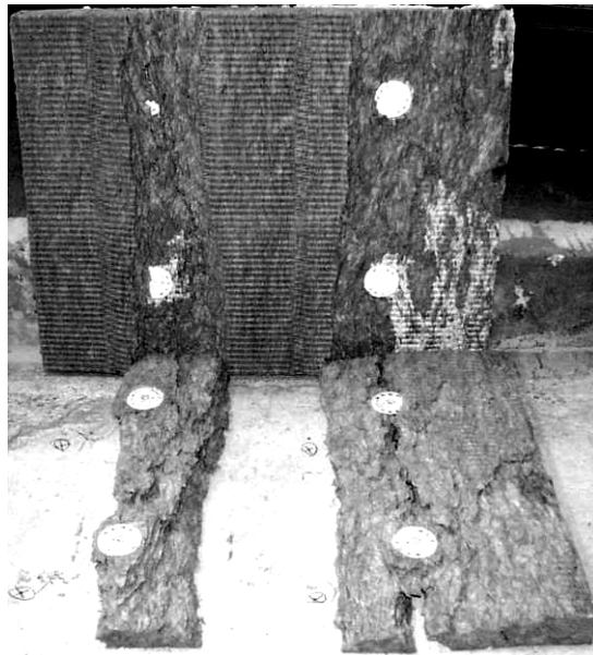
Bild 4.20 Typisches Versagensbild im Schaumblockversuche bei Mineralwolle-Dämmplatten
