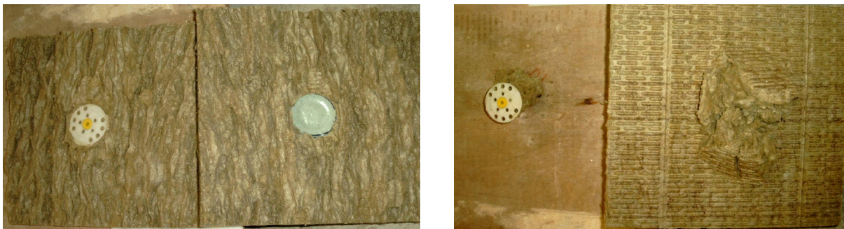
Bild 4.3 Versagensbilder zum Einfluss der Faserverläufe bei Mineralwolle
