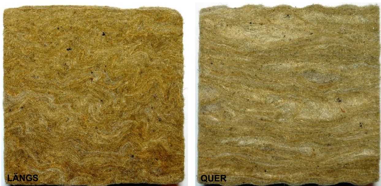
Bild 4.15 Faserverlauf in den Mineralwolle-Dämmplatten in Längs- und Querrichtung
