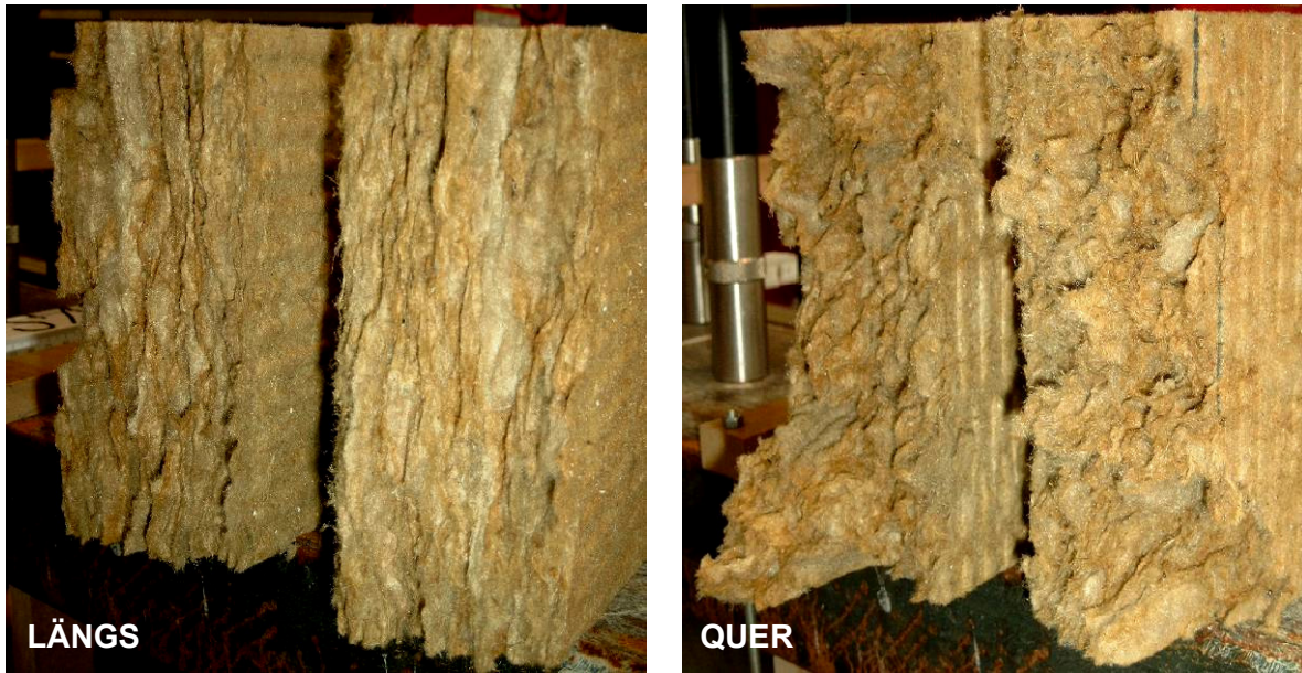
Bild 4.18 Bruchbild im Biegeversuch der Mineralwolle-Dämmplatten in Längs- und Querrichtung
