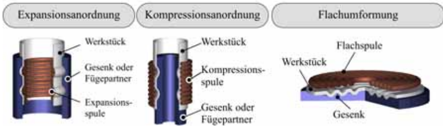
Bild 2.4 Verfahrensvarianten der EMU [Bee00]
