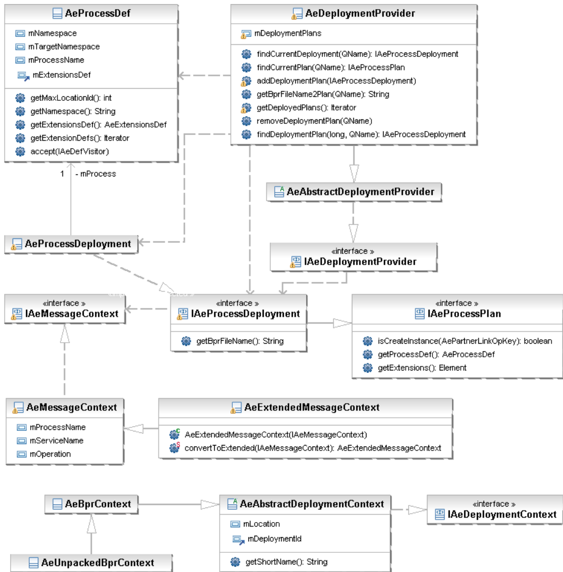
Abbildung 6.34: Überblick Klassenstruktur für das Ad-hoc-Deployment.
