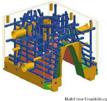
Abbildung 3.4: Beispiel eines Temperierbohrungssystems [VDW05]
