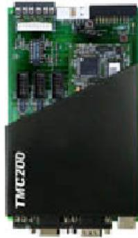
**Abbildung 2.10:** Der Motorcontroller TMC200
