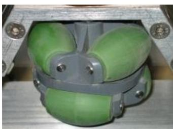
**Abbildung 2.2:** Omnidirektionales Rad. Die orthogonal zur Laufrichtung angebrachten Rollen (grün) ermöglichen Bewegungen nicht nur in der eigentlichen Rad-Laufrichtung, sondern auch orthogonal zu dieser.
