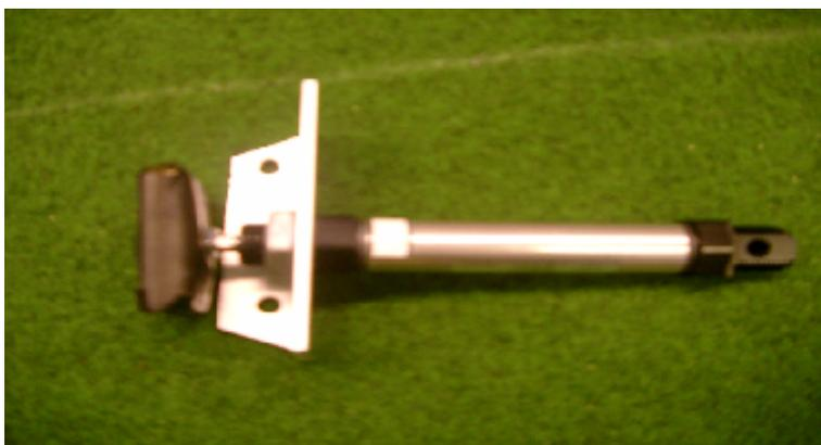
**Abbildung 4.4:** Schusseinheit bestehend aus einem Pneumatikzylinder mit Feder
