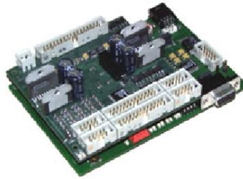
Abbildung 2.9: Das Robotic Extension Board für das Kameleon 376SBC
