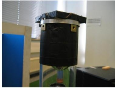
**Abbildung 2.5:** Montierte Spiegel-Trägerplatte. Der Spiegel ist erkennbar am unteren Ende der schwarzen Verkleidung der Plexiglasröhre, die Verkleidung dient dabei der Minimierung von Lichtreflexen in der Plexiglasröhre. Erkennbar ist außerdem die Befestigung der Trägerplatte mittels Metallwinkel.
