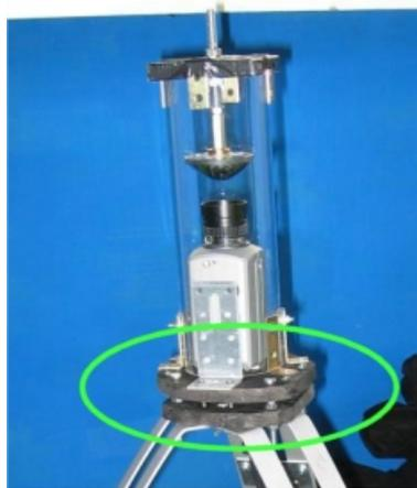
**Abbildung 2.6:** Befestigung des Kameramoduls. Zu erkennen ist die Verbindung des Kameramoduls mit der Steuer- und Kontrollmodul. Ferner erkennt man ebenfalls noch einmal die Befestigung des Spiegels und die unter diesem montierte Kamera.
