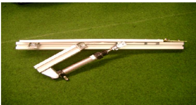
**Abbildung 4.6:** Schusseinheit bestehend aus einem Pneumatikzylinder (mit / ohne) Feder an einem Aluminiumhebel
