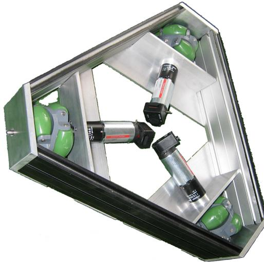
**Abbildung 2.3:** Fahrwerk-Draufsicht. Erkennbar sind die im  $120^\circ$ -Winkel zueinander stehenden Motoren, die die außen stehenden, omnidirektionalen Räder (grün) antreiben.
