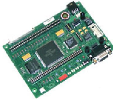
**Abbildung 2.8:** Das Motorcontroller-Board Kameleon 376SBC
