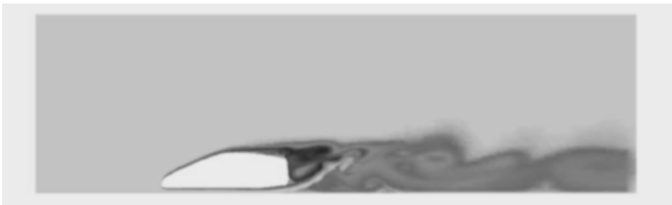
Abbildung 1.2: Visualisierung einer Fahrzeugumströmung, wie sie auf Grundlage der Konfiguration aus Abbildung 1.1 berechnet werden kann. Die Strömung ist per Shaded-Plot-Verfahren visualisiert. Erkennbar ist die Temperatur, je dunkler eine Stelle, desto wärmer ist sie. Am Anfang der Simulation ist nur die Fahrzeugkontur beheizt. Der Windstrom kommt gleichmäßig vom linken Rand. Am Verlauf der Temperatur ist das Strömungsverhalten erkennbar.
