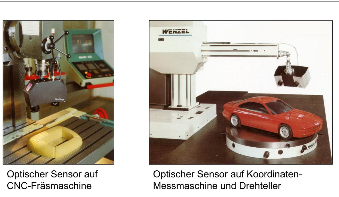
*Abb. 55: Kopplung von optischen Sensorsystemen mit positionsbestimmenden Maschinen*
