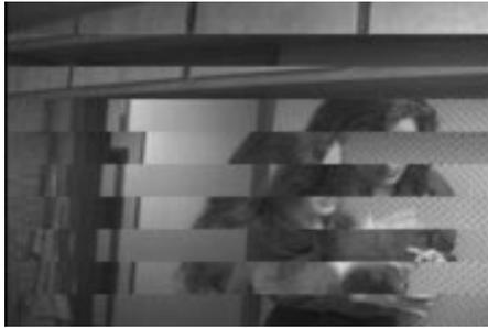
Diese Sorte von Bandeffekten entsteht bei einer kurzzeitigen Verschmutzung des Videoköpfe, welches durch einen Abrieb der ME Schicht des Videobandes passiert. Nach einigen Sekunden verflüchtigen sich diese Partikel.
