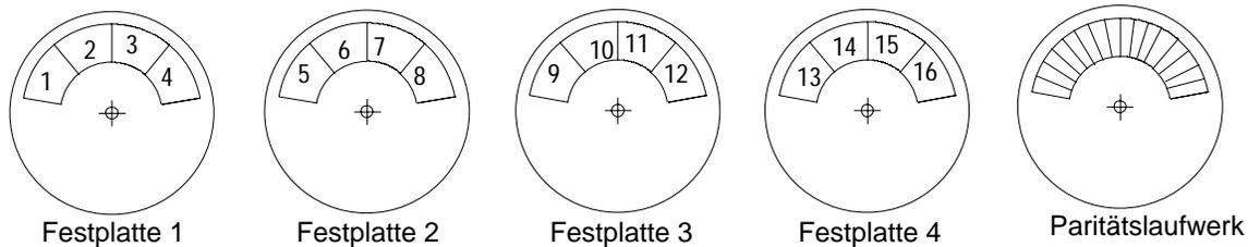
**Abb. 6:** Schreib- /Lesereihenfolge der Datensegmente bei RAID-4
