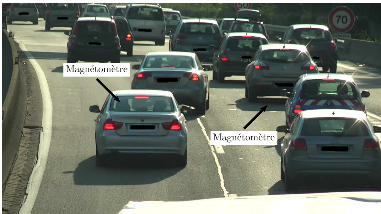
FIGURE 5.11 – Situation de freinage brusque sur les capteurs. L'emplacement des magnétomètres des voies lente et rapide est indiqué par des flèches.
