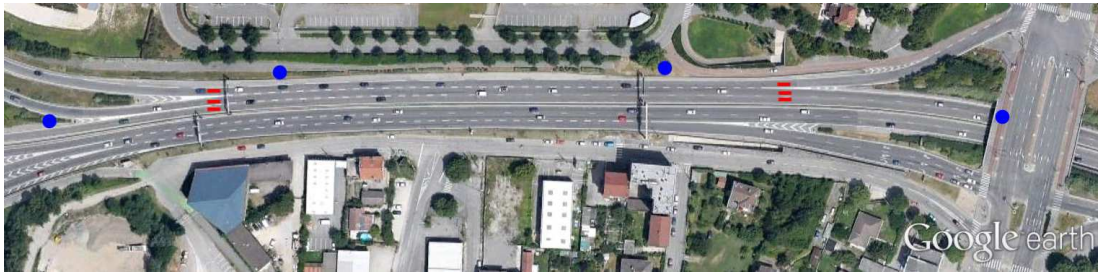
FIGURE 8.12 – Entrées – sorties de l'échangeur du Rondeau. En rouge l'emplacement des réseaux de capteurs et en bleu l'emplacement des caméscopes.
