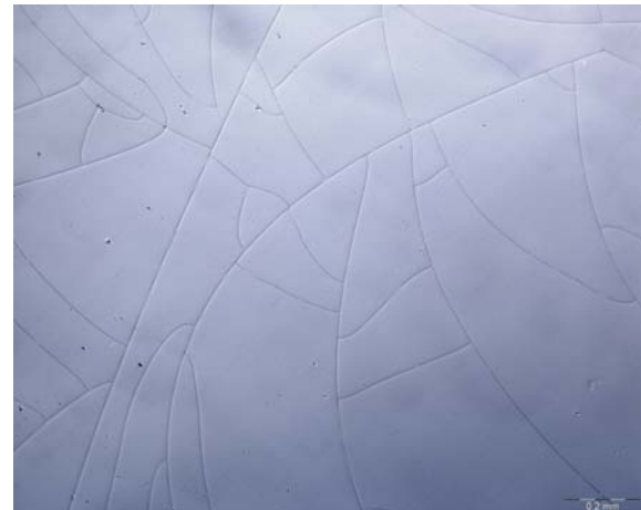
Image IV-4. Observation au microscope optique de fissures sur la surface irradiée des échantillons de verre Spectrosil ayant reçus des fluences de 3,2 \times 10^{12} \text{ Au/cm}^2 et 1,3 \times 10^{13} \text{ Au/cm}^2 .
