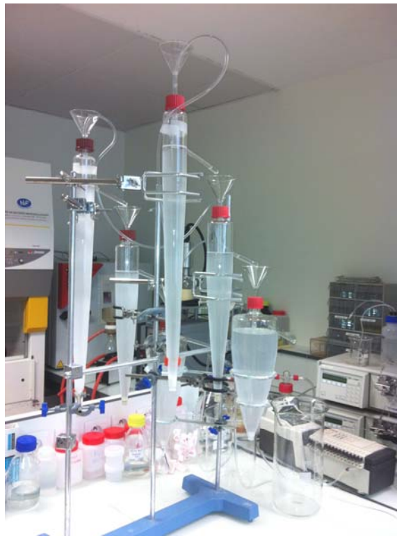
Image III-4. Séparation granulométrique de la poudre de verre ISG par deux bancs d'élutriation.
