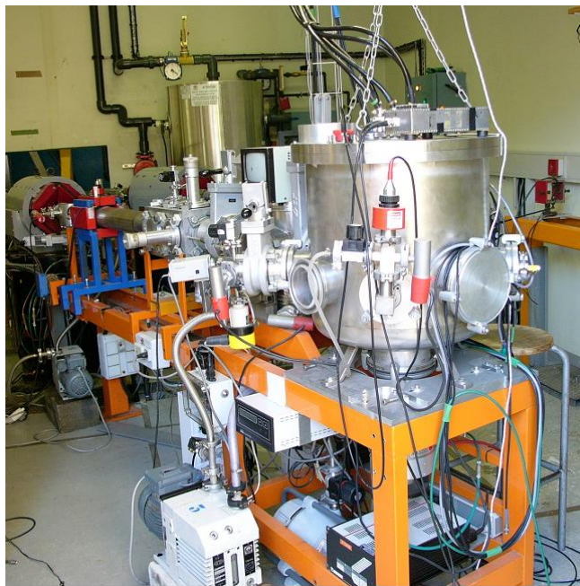
Image III-1. Ligne de faisceau de l'accélérateur VdG du CEMHTI utilisée pour les irradiations He 1MeV.
