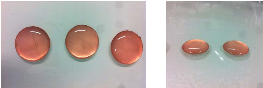
Image III-5. Solution de poudre de verre ISG sur des substrats en cuivre. L'adhésion de la monocouche se fait par l'évaporation de l'eau à température ambiante.
