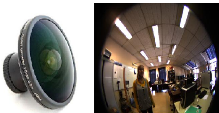
FIGURE 2.4 – Exemple de lentille fish-eye à gauche, d'image Fish-eye à droite.
