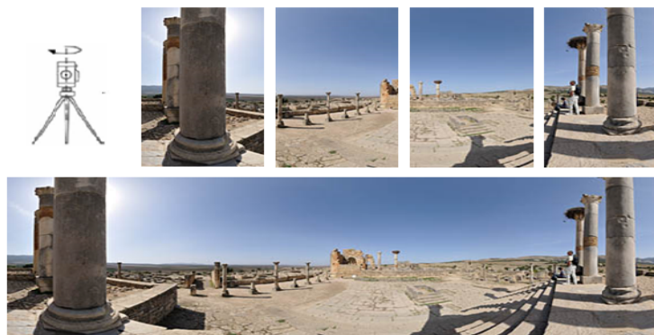
FIGURE 2.2 – Principe de système rotatif générant une image panoramique
