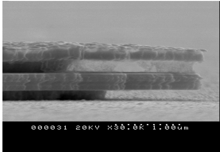
FIG. IV.24: Observation au microscope électronique à balayage de la gravure simultanée des couches de tungstène émetteur et collecteur.
