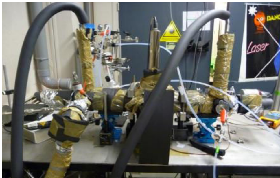
Figure 2.1: Photo du montage utilisant la cellule cryogénique à Rennes (inox)
