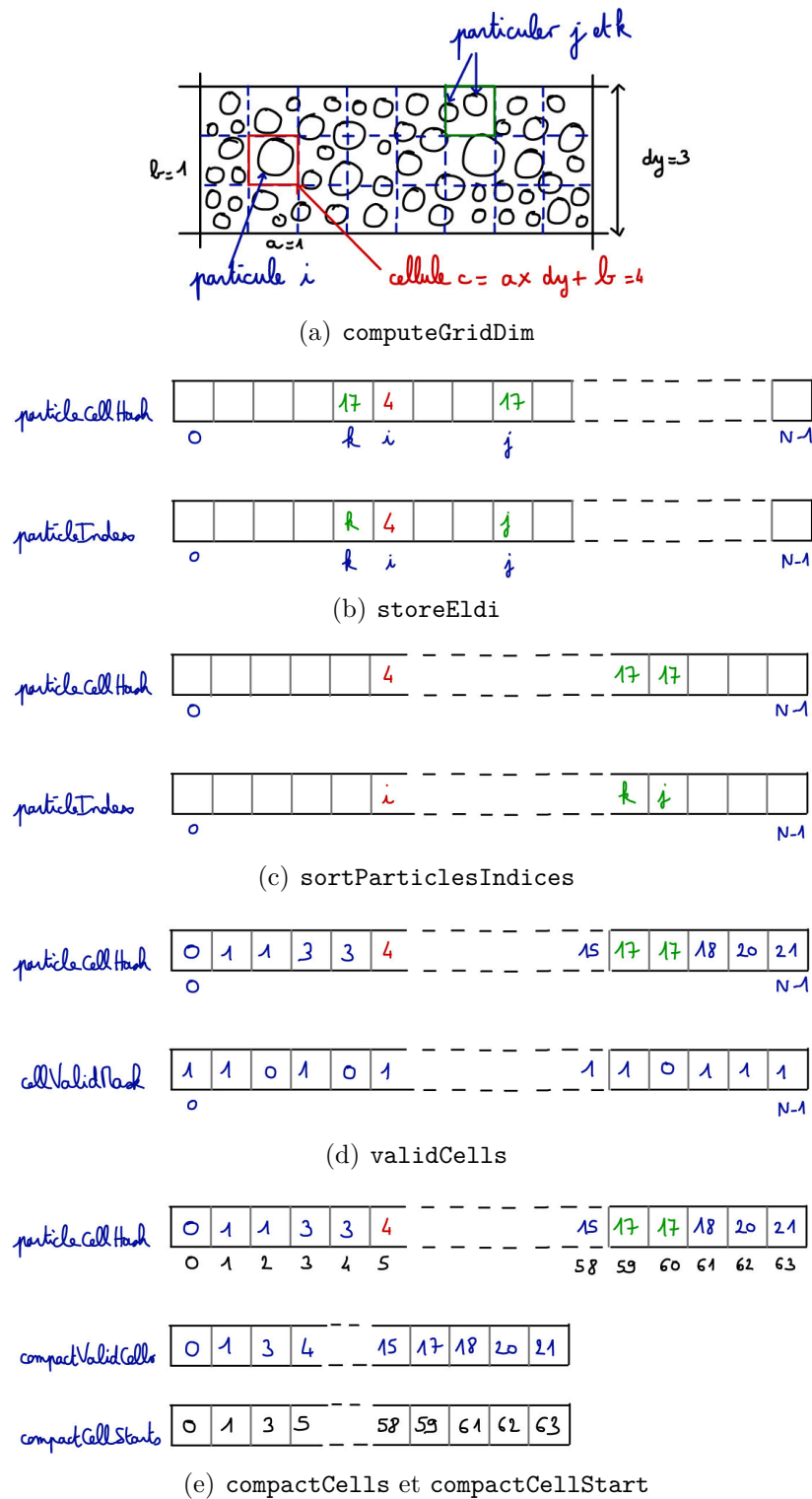
FIGURE 2.10 – Étapes de la détection de collision : calcul des dimensions de la boîte englobante (a), détermination du numéro de cellule de chaque élément (b). Tri des indices et des numéros de cellule dans l'ordre des numéros de cellule (c). Détermination des cellules valides (d). Compactage des cellules et des débuts de cellule valides (e).
