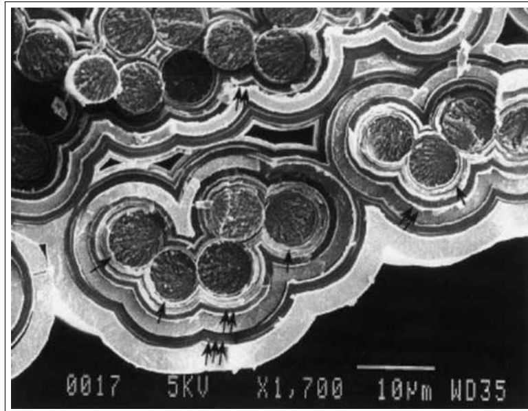
Figure 1.9 – Exemple de matrice multi-couche SiC/constituants borés [Lamouroux et al. , 1999b]
