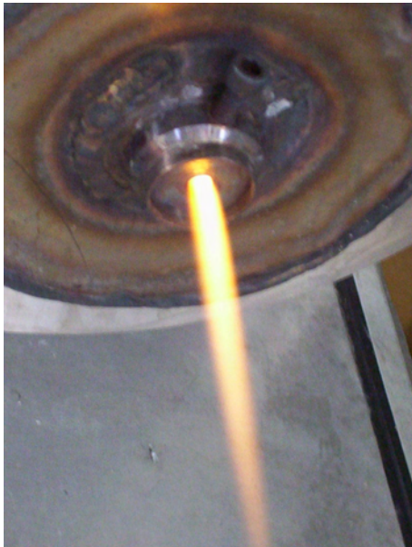
FIG. 3.21: Influence du débit d'eau sur la puissance dissipée dans l'arc. I = 500 \text{ mA}
