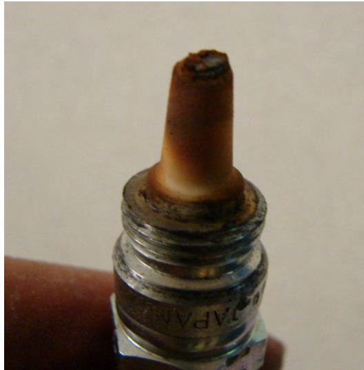
FIG. 3.8: Photographie de l'électrode pointe après utilisation en configuration cathode-pointe
