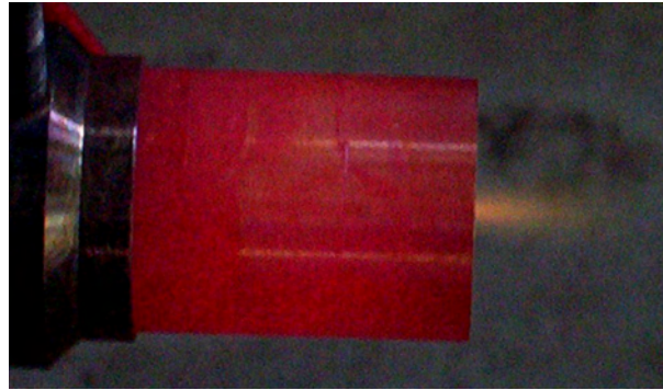
FIG. 3.14: Photographie de la tuyère et de la zone d'extinction pour le cas L = 80 mm. Débit : 0.29 g/s. Cas de l'eau. Régime glidar
