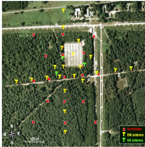
FIGURE 2.1 – La configuration géométrique de l'expérience CODALEMA II à l'observatoire radioastronomique de Nançay.
