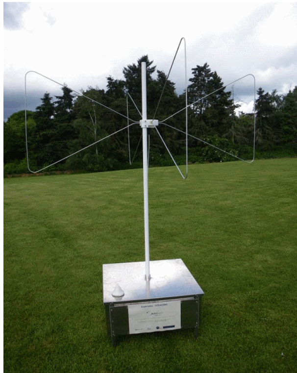
FIGURE 2.13 – Prototype 1 de la Station Autonome conçue au laboratoire Subatech par l'équipe astroparticule. L'antenne possède deux radiateurs. Toutes les cartes électroniques sont contenues dans le caisson métallique servant de blindage électronique vis à vis des antennes de détection placées au-dessus. Le cône blanc dans le coin avant gauche est le capteur GPS.
