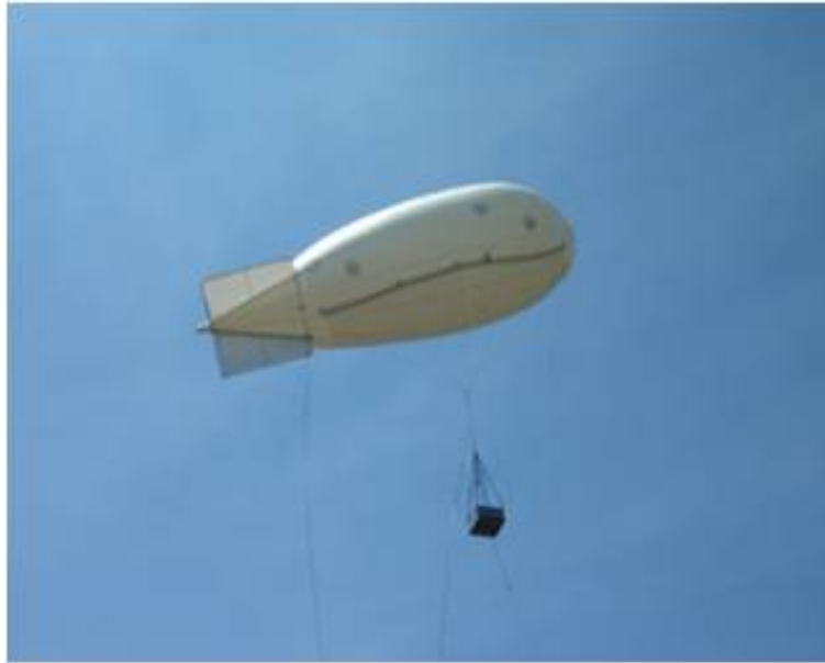
FIGURE 4.21 – Expérience Gerbes 3D : consiste à embarquer une station autonome sous un ballon captif.
