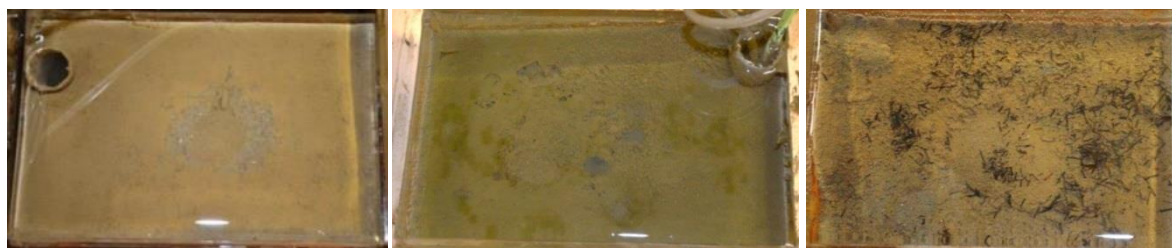
Figure IV.6 : photographies de l'interface eau-sédiment de trois aquariums (taille intérieure de 11,5×17,5 cm). A gauche un aquarium témoin, au centre un aquarium après apport de Tetraselmis sp. et à droite un aquarium après apport de débris de Zostera noltei .
