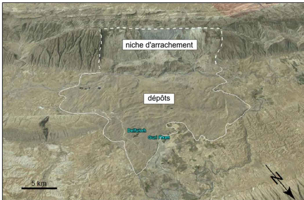
Figure I.4. Niche d'arrachement et dépôts de l'avalanche de débris de Saïdmarreh (Iran, ©Google Earth).
