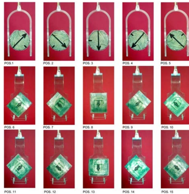
Figure V.3. Photographies d’un échantillon de carotte disposé dans un porte-échantillon amagnétique en plastique montrant les 15 positions de mesures à l’aide du Kappabridge.
