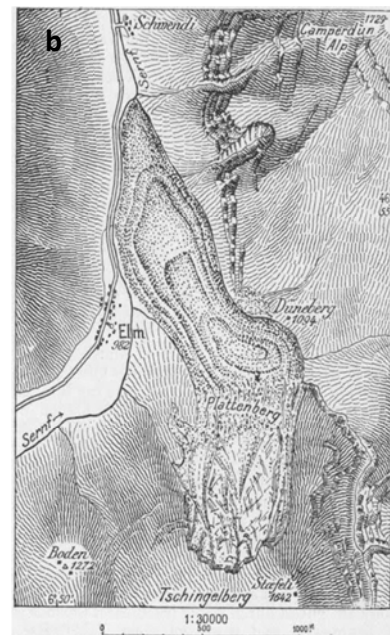
Figure I.1. Présentation de l'avalanche de débris d'Elm (Suisse) (a) Reproduction de l'avalanche de débris d'Elm, vue depuis la partie distale (Heim, 1882). (b) Carte des dépôts de l'avalanche de débris d'Elm (Heim, 1882). On remarque la forme lobée des dépôts qui témoigne d'une mise en place à la faveur d'un écoulement.
