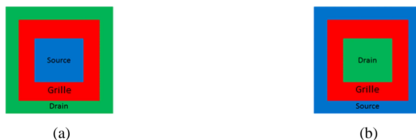
Figure 1.17 : Représentation des transistors fermés à source centrale (a) et à drain central (b).
