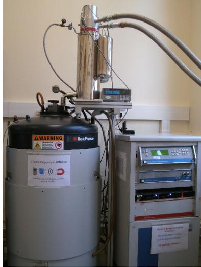
FIGURE 2.3 – Le PPMS (Physical Property Measurement System) de *Quantum Design* de l'ESPCI ParisTech. A gauche, le cryostat avec sa bobine de 13T. A droite, l'alimentation. Au milieu au-dessus du cryostat, le système de reliqufaction de l'hélium.
