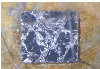
FIGURE 2.1 – Face perpendiculaire à l’axe trigonal d’un échantillon de bismuth fraîchement clivé. La surface est alors très brillante. Les losanges visibles sur cette face sont les plans binaires du cristal.
