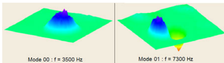
FIGURE 4.10 – Mesures des 2 premières déformées modales d'un speaklet du HPDM macroscopique
