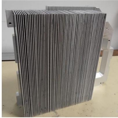
Figure 4-14 Photo du dissipateur des modules IGBT
