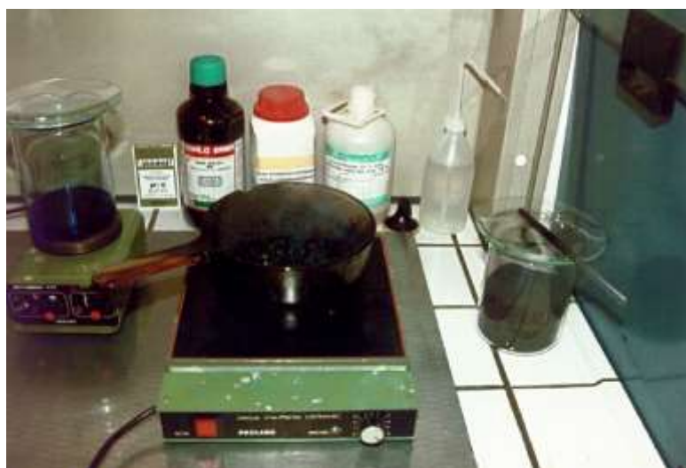
Figure 2.5a — A gauche : le mélange des solutions 1 et 2 ; au centre : le gel, en début de décomposition ; à droite : le précurseur après brûlage.
