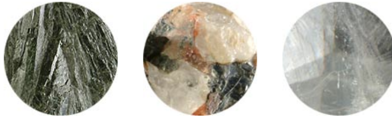
FIGURE 1.24 – Exemples d’échantillons avec des degrés de transparences différentes. (a) grain opaque (hornblende), (b) grain translucide (biotite), et (c) grain transparent (calcite). (credit : University of Auckland, New Zealand).
