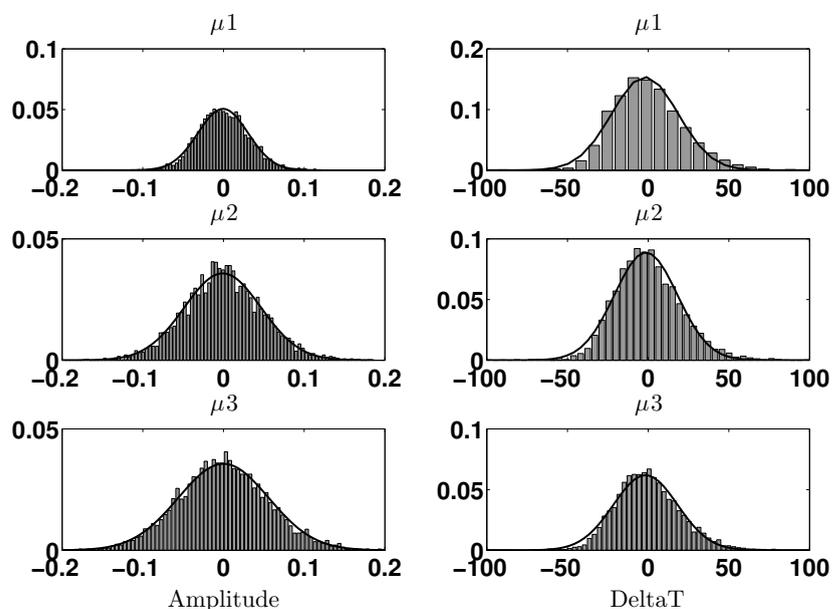
FIGURE A.2 – Variation du paramètre  $\mu$ . Barres : densité de probabilité estimée de  ${}^c\tilde{A}$  (gauche) et  ${}^c\tilde{\Delta}_T$  (droite). Courbe noire : estimation par les moindres carrés des lois gaussiennes.
