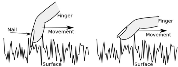
FIGURE III.1 – Un ongle qui gratte une surface (gauche), un doigt qui frotte une surface (droite). L'axe vertical représente la hauteur des aspérités de la surface (exagérée pour la clarté de la figure); l'axe horizontal représente la direction dans laquelle le doigt se déplace.
