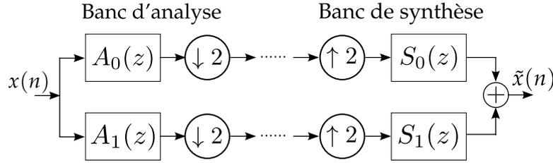
FIGURE IV.5 – Banc de filtres QMF de base.
