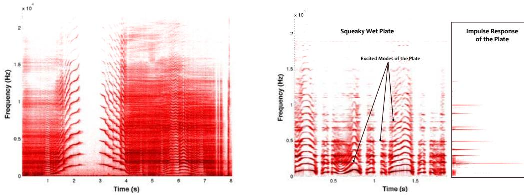
FIGURE III.13 – Représentation temps-fréquence d’un son de porte grinçante (gauche) et des sons de couinements produits par un doigt humide sur une assiette (droite). Figures extraites de (Thoret *et al.*, 2013).
