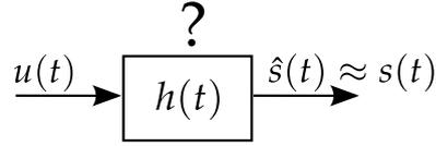
FIGURE IV.2 – Position du problème : étant donnée une texture sonore  $s(t)$  connue, comment estimer le filtre  $h(t)$  tel que  $s(t) \approx \hat{s}(t) = [h * u](t)$ , où  $u$  est un bruit blanc gaussien de moyenne nulle et où  $\hat{s}$  représente la texture estimée ?
