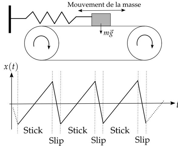
FIGURE III.12 – Modèle phénoménologique du “collé-glissé” (“stick-slip” en anglais)
