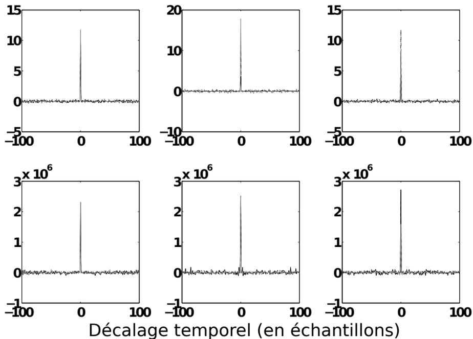
FIGURE II.9 – Autocorrélation des signaux blanchis  $\tilde{c}A^n$  (ligne supérieure) and  $\tilde{c}\Delta_T^n$  (ligne inférieure) pour des filtres blanchisseurs à 1 pôle-1 zéro. Les paramètres et couleurs utilisés sont les mêmes que figure II.5.
