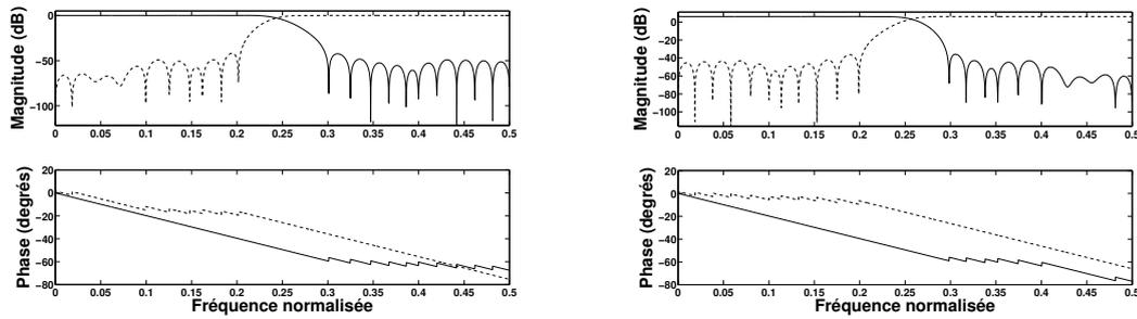
FIGURE IV.8 – Réponse en fréquence des filtres d’analyse (gauche,  $A_0(z)$  en trait plein,  $A_1(z)$  en pointillés) et de synthèse (droite,  $S_0(z)$  en trait plein,  $S_1(z)$  en pointillés) du banc QMF à 2 canaux.
