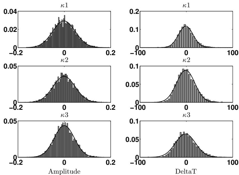
FIGURE A.1 – Variation du paramètre  $\kappa$ . Barres : densité de probabilité estimée de  ${}^c\tilde{A}$  (gauche) et  ${}^c\tilde{\Delta}_T$  (droite). Courbe noire : estimation par les moindres carrés des lois gaussiennes.
