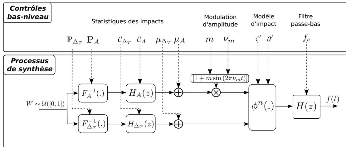
FIGURE III.9 – Schéma de synthèse général et contrôles bas-niveau.
