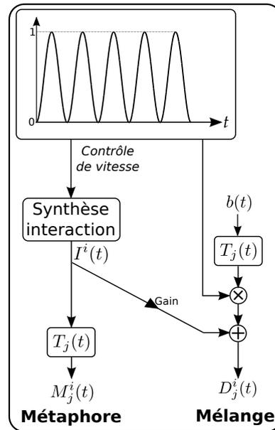
FIGURE IV.16 – Génération de la métaphore  $M_j^i(t)$  et du mélange  $D_j^i(t)$ , obtenus à partir de l'interaction  $I^i(t)$  et du filtre  $T_j(t)$  estimé sur la texture  $\mathbb{T}_j$ .  $b(t)$  est un bruit blanc gaussien.
