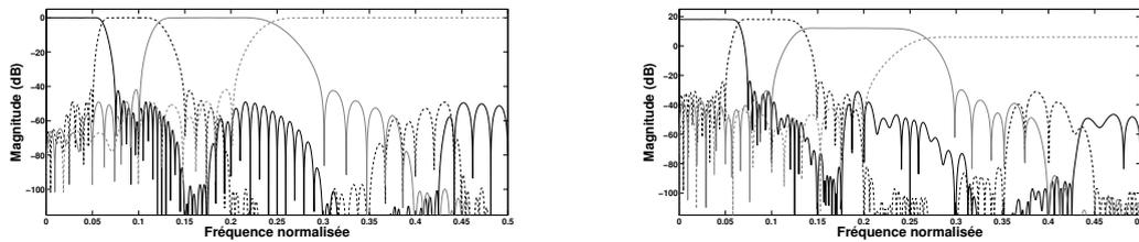
FIGURE IV.9 – Réponse en fréquence des filtres d’analyse (gauche,  $D_1(z)$  en trait plein noir,  $D_2(z)$  en pointillés noirs,  $D_3(z)$  en trait plein gris,  $D_4(z)$  en pointillés gris) et de synthèse (droite,  $R_1(z)$  en trait plein noir,  $R_2(z)$  en pointillés noirs,  $R_3(z)$  en trait plein gris,  $R_4(z)$  en pointillés gris) du banc QMF à 4 canaux.
