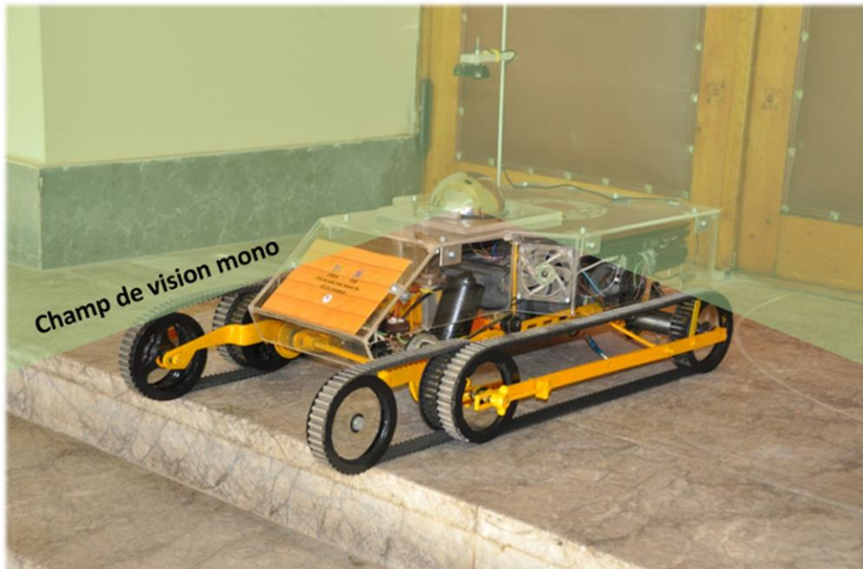
Figure 4.6 : Capteur de vision omnidirectionnelle monoculaire.
