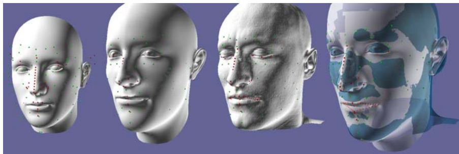
(a) Exemple complet de morphisme du visage neutre vers le visage recherché. De gauche à droite : visage neutre présenté face aux points cutanés recherchés, visage estimé par déformation, visage réel de l'inconnu et la superposition du visage estimé en bleu au visage réel en blanc.
