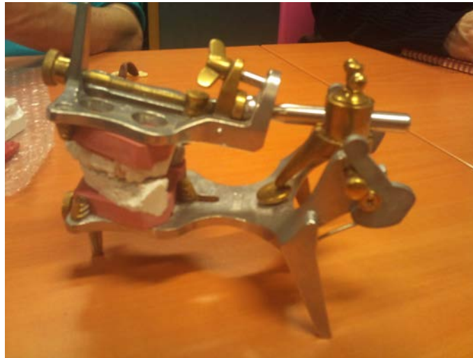
FIGURE 5.3 – Articulateur de moules dentaires pour planifier le mouvement entre la mandibule et le maxillaire.
