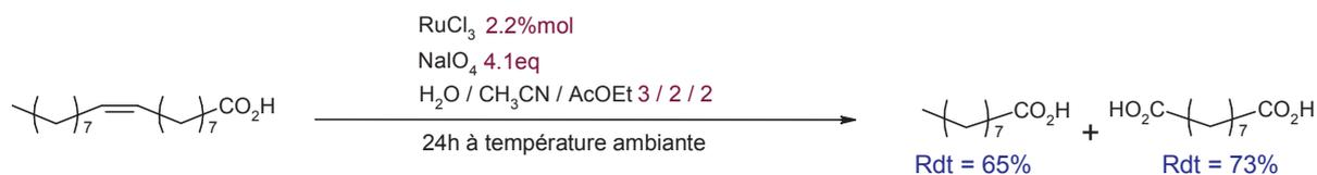
Figure 18 – Clivage oxydant de l'acide oléique en présence de  $\text{RuCl}_3/\text{NaIO}_4$ <sup>80</sup>
