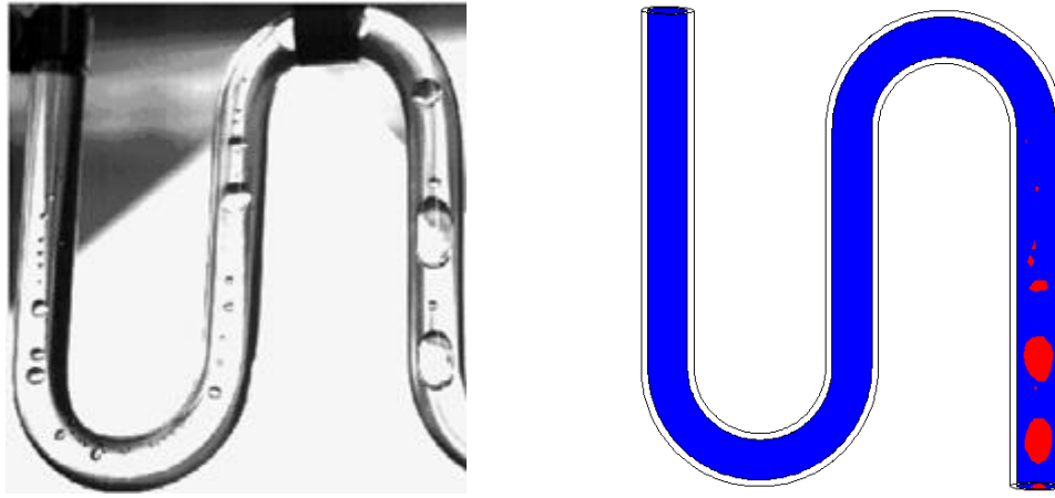
Figure IV-27. A gauche, cas expérimental n°1 de Yang et al. [91]. A droite, résultat de nos calculs.
