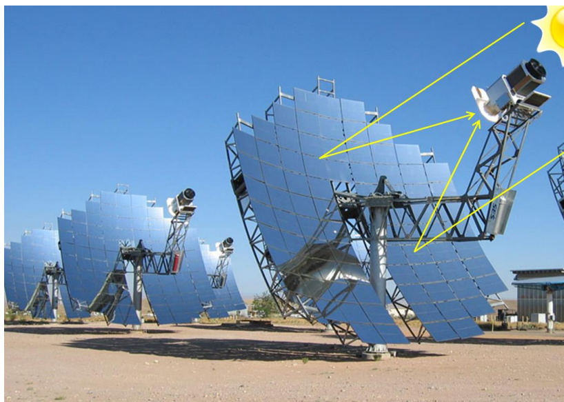
Figure I-2. Principe d'un concentrateur parabolique (Photo : Stirling Energy Systems)
