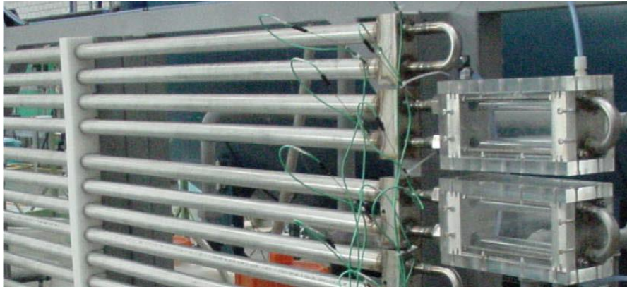
Figure II-24. Photo de l'évaporateur (avant isolation) et des zones de visualisation [106]
