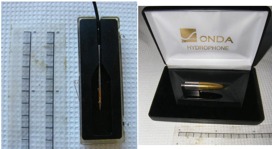
FIGURE 2.1: (a) Photographie d'un hydrophone piézoélectrique aiguille (PZT-Z44-0400-H816, Speciality Engineering Associates, Sunnyvale, CA, USA). (b) Photographie d'un hydrophone piézoélectrique de type "Lipstick" (HGL-200-1113, Onda Corporation, Sunnyvale, CA, USA).
