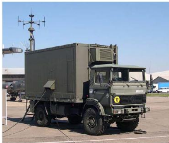
Figure 9: SCRIBE : Système de radiolocalisation, d'interception, de brouillage et d'écoute.
