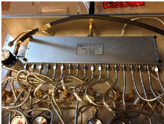
Figure III-14: Le prototype complet (a) BFN vu de dessous (b) BFN vue en zoom et (c) dans la chambre anéchoïque de XLIM.
