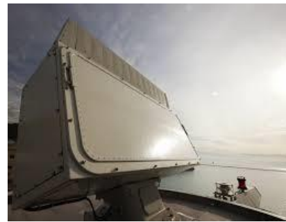
Figure 7: Le radar KRONOS installé sur un bateau militaire.
