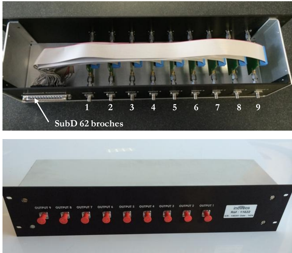
Figure IV-15: Boîtier contenant 9 déphaseurs numériques alimentés et commandés simultanément par un subD à 62 broches.
