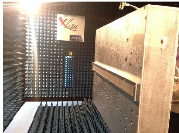
Figure III-14: Le prototype complet (a) BFN vu de dessous (b) BFN vue en zoom et (c) dans la chambre anéchoïque de XLIM.
