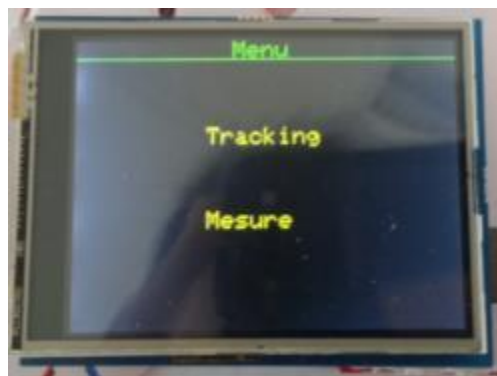
Figure IV-18: Ecran LCD affichant les deux menus principaux (mesure et 'Tracking').
