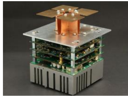
Antenne élémentaire en présence des étages d'amplifications, de déphasages, de contrôle...
