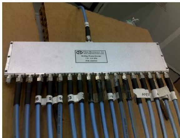
Figure III-15: Mesure du diviseur de puissance de commerce (18-Way Power Divider, Clear Microwave Inc).
