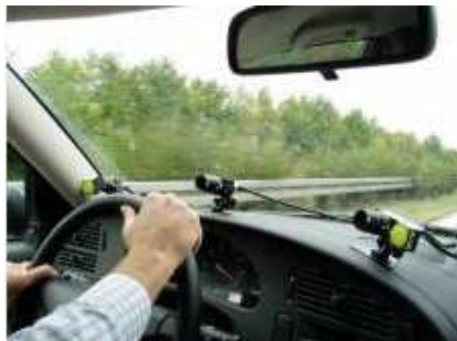
Figure 1.8 – Système multi-caméras Smart Eye Pro 5.10
