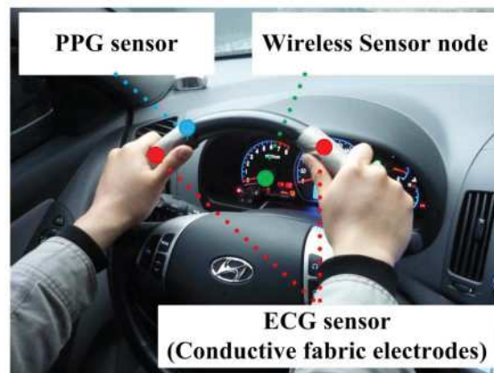
Figure 1.3 – Système d'acquisition et de transmission des signaux ECG et PPG à partir de capteurs placés sur le volant (Shin et al. , 2010)
