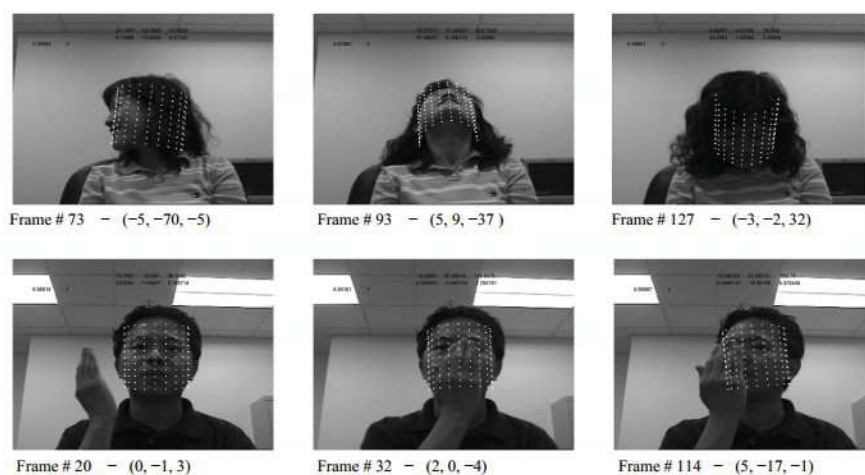
Figure 4.3 – Résultats du suivi par le filtrage particulaire sur des points caractéristiques d'un modèle cylindrique de la tête (Aggarwal et al. , 2005), affichés par la grille cylindrique. Les 3-uplets correspondent aux orientations estimées (roll,pitch,yaw)
