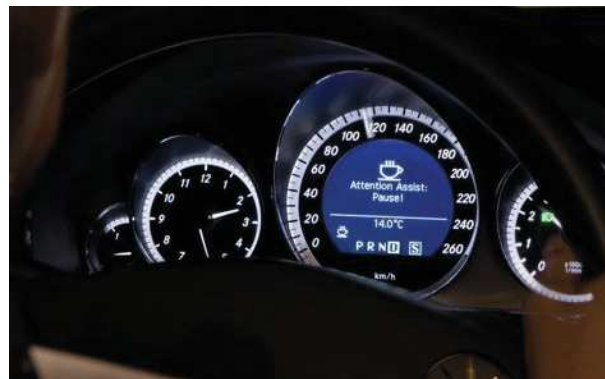
Figure 1.6 – Signal visuel émis par le système Attention Assist en cas d'hypovigilance
