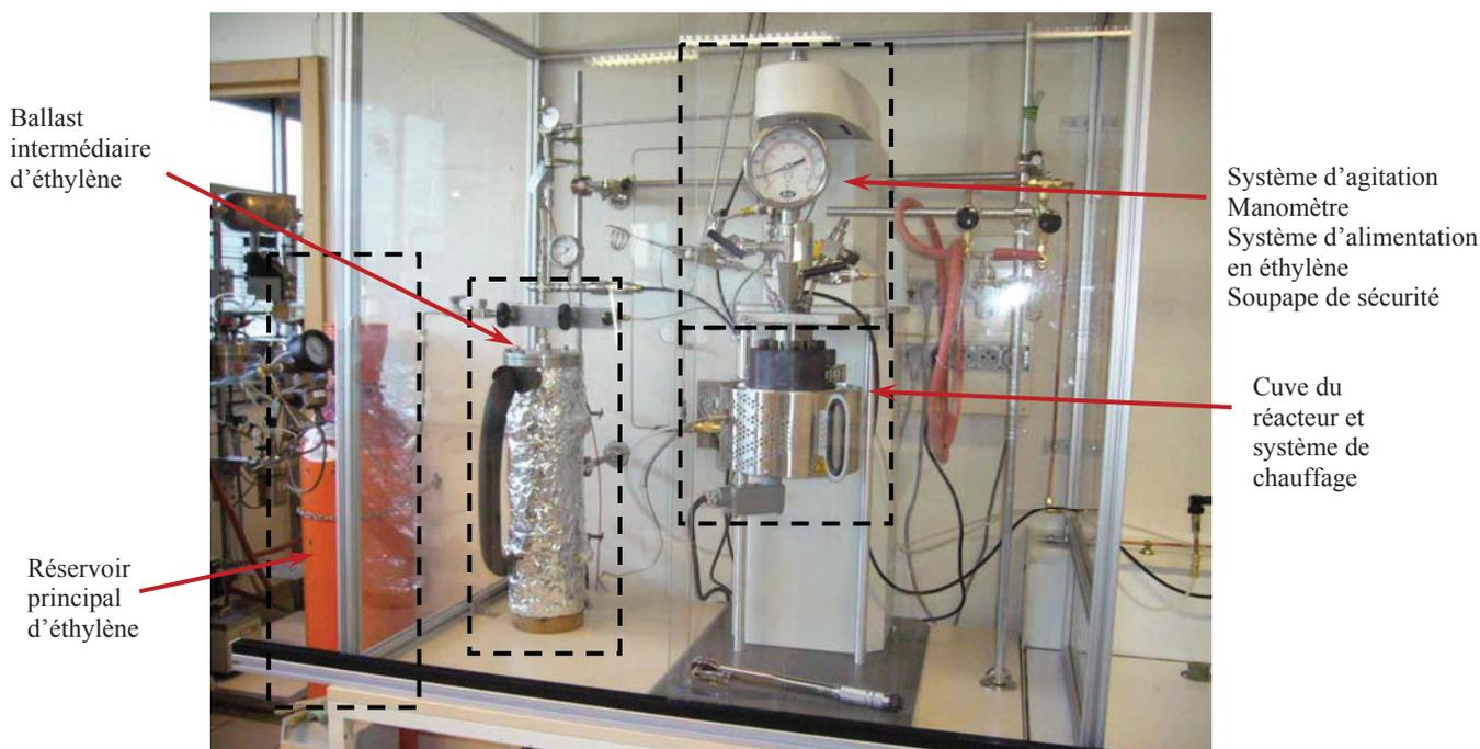
Figure 2. Réacteur de polymérisation de l'éthylène à 20 – 200 bar.
