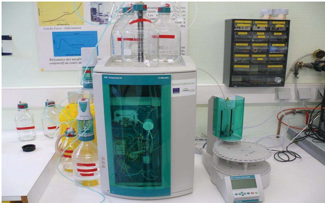
Figure 2.5 : Photographie de l'appareil de chromatographie ionique du laboratoire utilisé pour le dosage des ions chlorure ou sodium.
