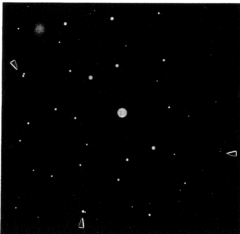
Figure 5.4 Diagramme de diffraction électronique de la structure présentée sur la figure 5.3. Les flèches indiquent le dédoublement des taches de diffraction (210).
