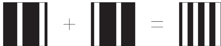
FIGURE 1.34 – La technique de double exposition permet de créer un réseau de ligne jusqu'à deux fois plus dense qu'en simple exposition, en n'imprimant qu'une ligne sur deux avec chaque exposition.
