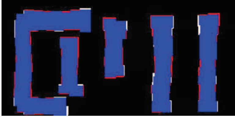
FIGURE 6.3 – Lors du calcul de l’OPC pour un même ensemble de structure en utilisant deux sources différentes, deux OPC différents sont obtenus. Les zones bleues correspondent aux endroits où les deux OPC sont retrouvés, tandis que les zones blanches et rouges représentent les endroits où seul l’un ou l’autre des OPC est retrouvé. Ceci illustre les différences induites sur l’OPC par le changement de la source dans le modèle optique.
