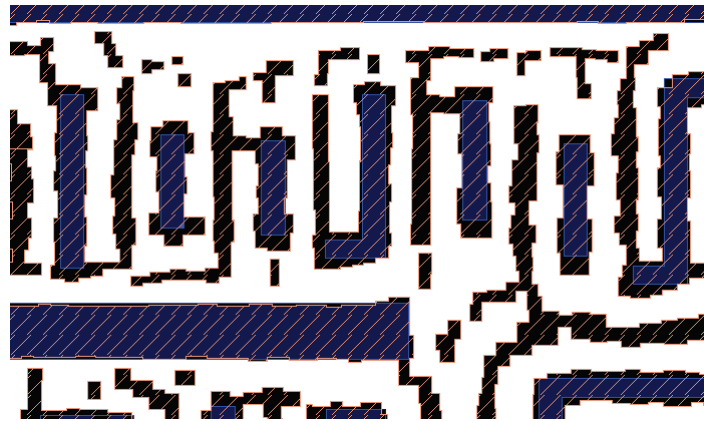
FIGURE 6.2 – Lors d'un OPC inverse, afin de reproduire les motifs (en rayés bleus), un masque (en noir) complètement décorrélié du motif est généré par le calcul. Ces motifs complexes sont parfois difficiles à créer sur le masque et ne sont pas toujours nécessaires. Ils augmentent alors la complexité, donc le prix du masque pour un gain parfois inutile.
