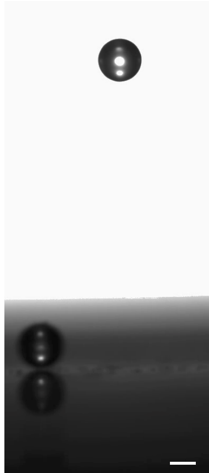
FIGURE 60 – Lévitiation d'une sphère par la pince acoustique. Photo de la lévitation d'une sphère dans sa position d'équilibre. La barre d'échelle représente 200\mu\text{m} .
