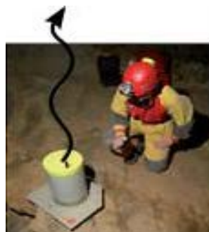
Figure 3-5 : Photo de la balise émettrice de l'UGPS placée en souterrain.
