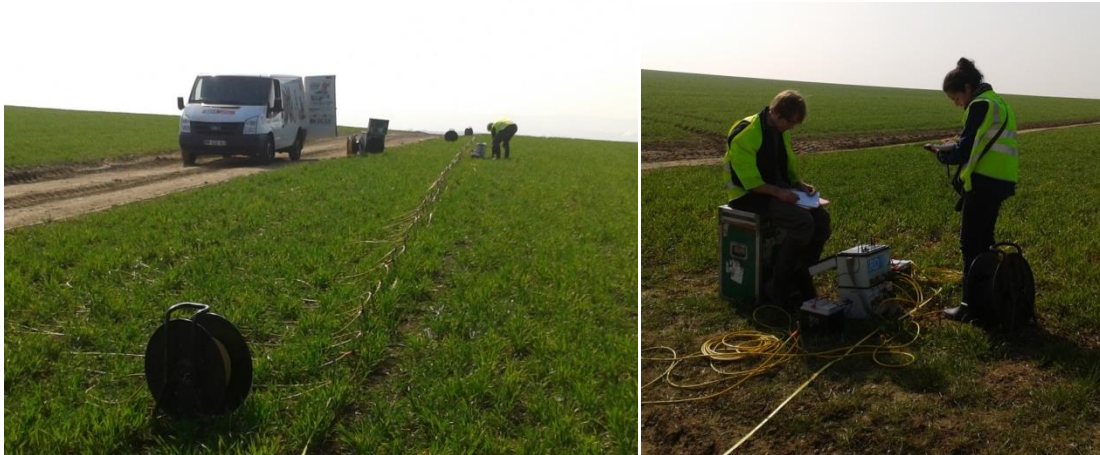
Figure 3-6 : Photos d'une acquisition de tomographie de résistivité électrique réalisée au-dessus de la cavité.
