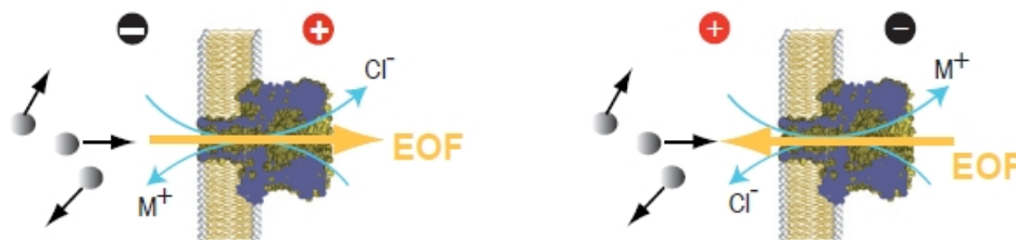
FIGURE 3.1 – Schéma de l'écoulement électroosmotique à travers le nanopore d'α-hémolysine. L'EOF est orienté dans le sens du transport des anions. En fonction du signe du voltage appliqué, l'EOF peut aider l'insertion des βCD dans le pore (gauche) ou s'y opposer (droite).
