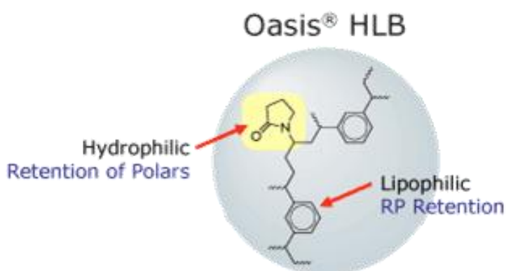
Figure 144 : Représentation du copolymère HLB (Adaptée de la plaquette commerciale Waters HLB [535])
